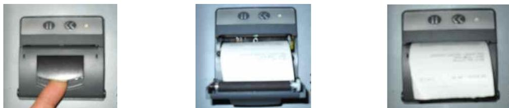
Figura 8 - Operazioni per la sostituzione della carta
